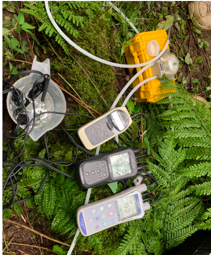
地下水の採水の様子。温度や pH などの項目は現地で測定します。左上の黄色いモノは汲み上げ用の簡易ポンプです。
