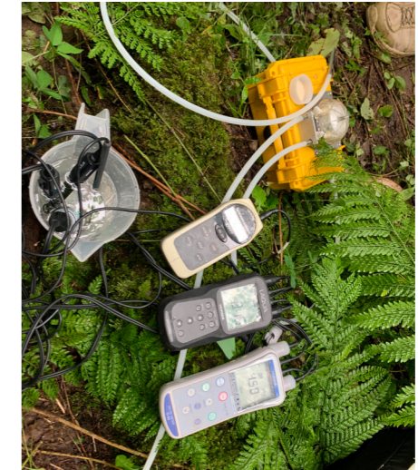
地下水の採水の様子。温度や pH などの項目は現地で測定します。左上の黄色いモノは汲み上げ用の簡易ポンプです。
